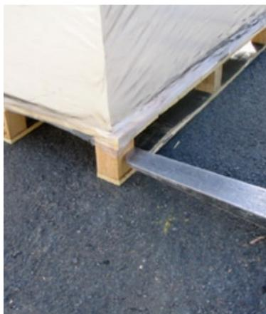
*Palettenfuß wird von Gabelzinke beschädigt*
