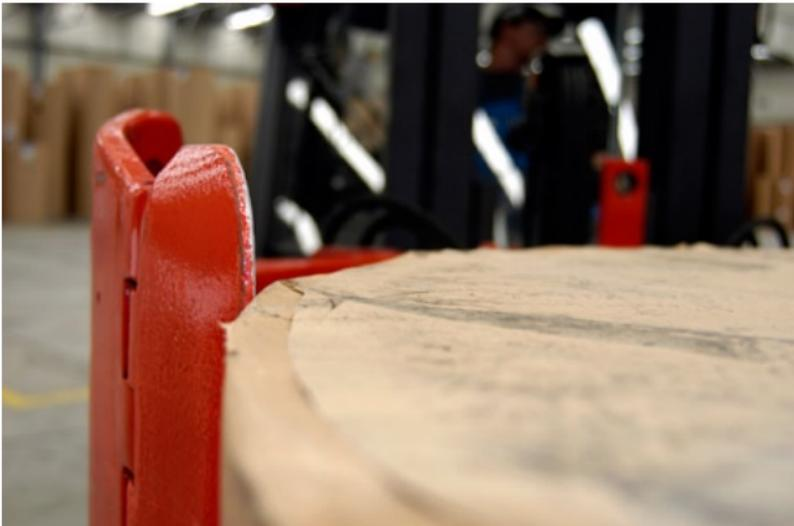
*die Kontaktplatte kann die Rolle beschädigen*
