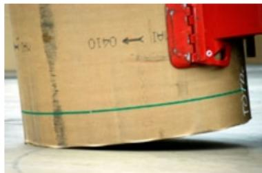
*Kantenschaden durch schräges Absetzen*
