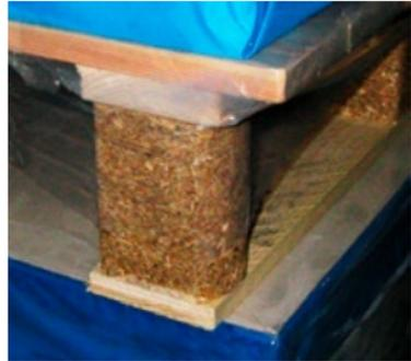
*Palettenklotz aus Pressspan*
