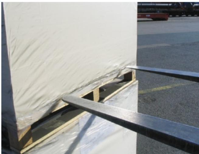
*Perforation der Verpackung, Beschädigung des Papierstapels*
