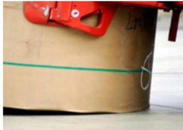
*Kantenschaden durch schräges Absetzen*
