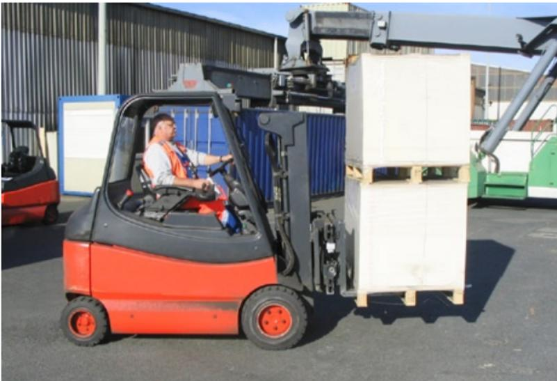
*Kippgefahr bei einer Notbremsung*
