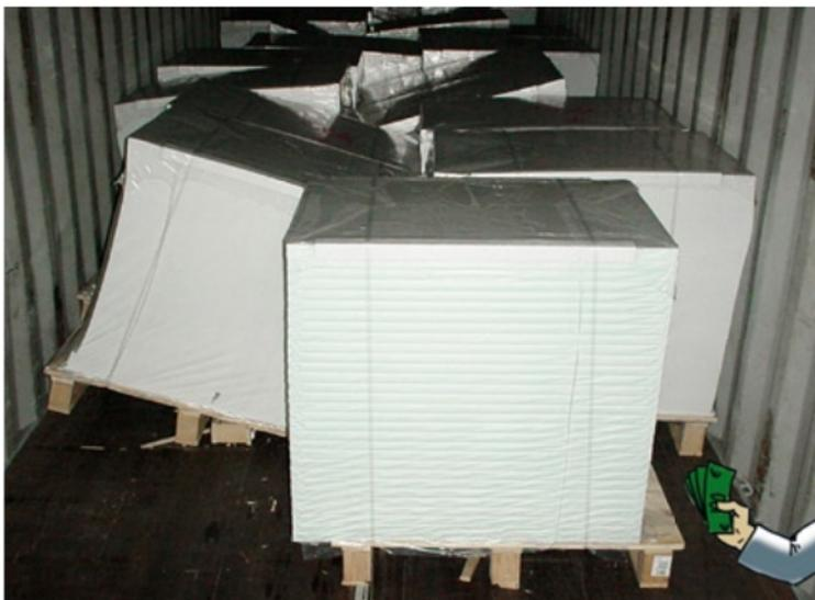
*zerstörte Ladeeinheiten aufgrund von Freiräumen*
